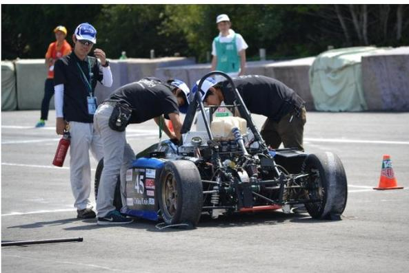
2日目は早朝から車検に向かいました。技術車検からチルト試験、ブレーキ試験、騒音試験と大きなトラブルもなく通過し、予定通り午前中には全ての車検に合格することができました。午後からはコスト審査、プレゼン審査の静的審査が行われました。コスト審査では車両を前に事前に提出したコストレポートと見比べながら製造プロセス等について質疑応答が行われます。プレゼン審査では好成績を収めた昨年度から新たに考えたビジネスプランを発表させて頂きました。静的審査を無事に
