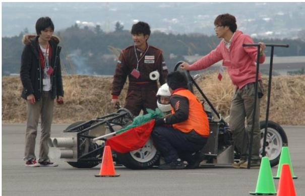
いくつかの修正の後に燃料漏れテスト、騒音テストをクリアしブレーキテストに臨みました。しかしブレーキテストでは車輪はロックしましたが定められた区間内での加速が不十分であったため合格とはならず、翌日へ持ち越しとなりました。
