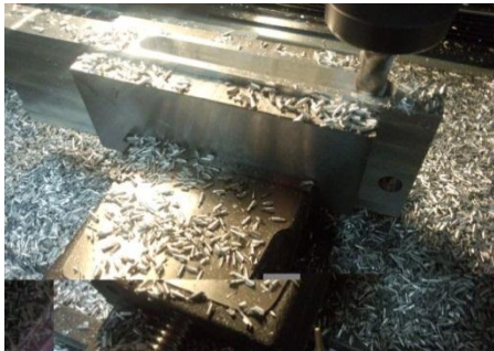
ベルクランクの肉抜き加工
